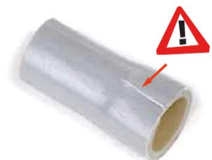
Мал.7. Пошкодження труби під час розширення несправною насадкою.
